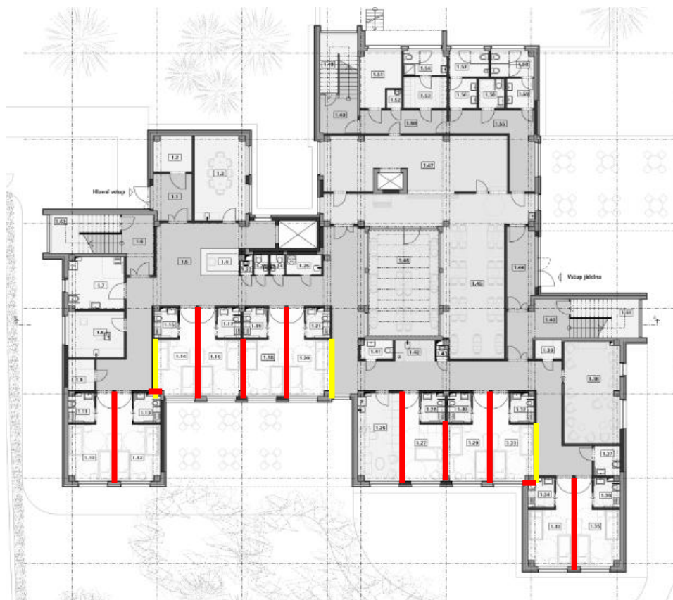
Obr. 2: 1NP s vyznačením konstrukcí chráněných prostor (červeně označené jsou konstrukce pokoj x pokoj ( R'_{w} \geq 53 dB), žlutě konstrukce pokoj x chodba ( R'_{w} \geq 52 dB)).
